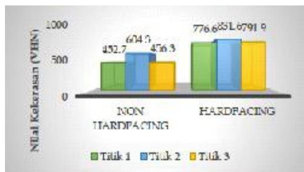
Gambar 1. Hasil Pengujian Kekerasan Mata Pisau
